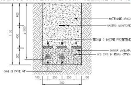
TRINCEA SU STRADA STERRATA SEZIONE TIPO "B1"
